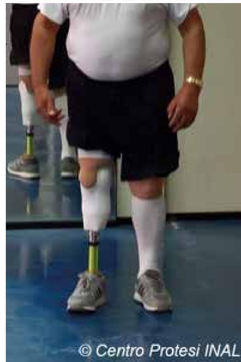
Primi test di invasature per amputati transtibiali stampate in 3D, realizzate dal Centro Protesi INAIL in collaborazione con importanti industrie del settore.
